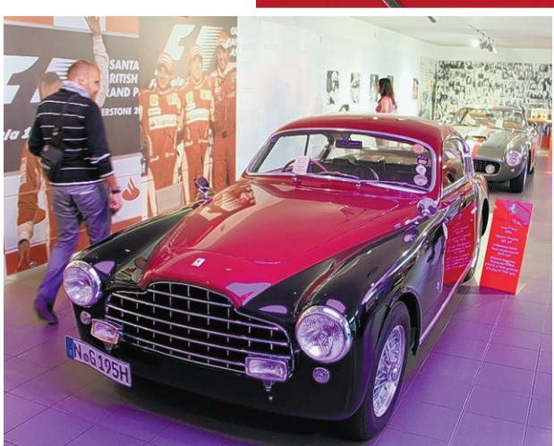
Edel: Ein Ferrari 195 Inter, Baujahr 1950. Die 195 steht für Kubikzentimeter pro Zylinder. Davon hat das Auto zwölf.
